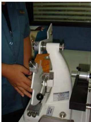
ภาพที่ 5 การทดสอบความต้านแรงฉีกขาด (Tearing Strength)
