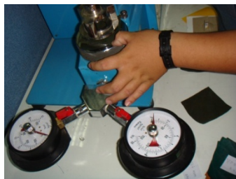
ภาพที่ 4 ทดสอบความต้านทานแรงดันทะลุ (Bursting Strength Tester)
