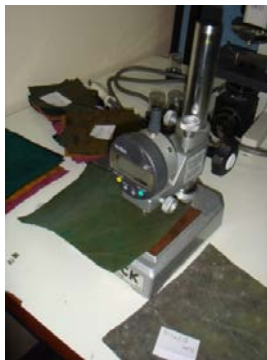
ภาพที่ 3 การทดสอบความหนา (Thickness Tester)
