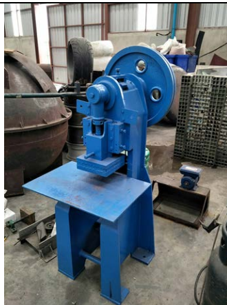
รูปที่ 11 เครื่องป้อนตัดใบบัวดำเนินการเรียบร้อยแล้ว คงเหลือการสร้างชุดลำเลียงบัวก่อนเข้าแท่นพิมพ์ และทำการทดสอบ
